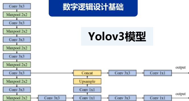
YOLOv3网络结构
