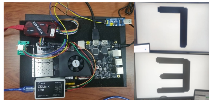
LeNet手写数字识别效果展示图：(a)-(b)课堂情况；(c)实验开发板；(d)显示结果输出
